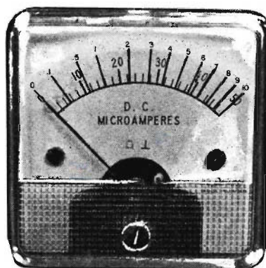
Fig. 4 - La taratura dello strumento indicatore si ottiene rinnovando la scala originale del microamperometro, ottenendo una nuova suddivisione ed una nuova numerazione.
